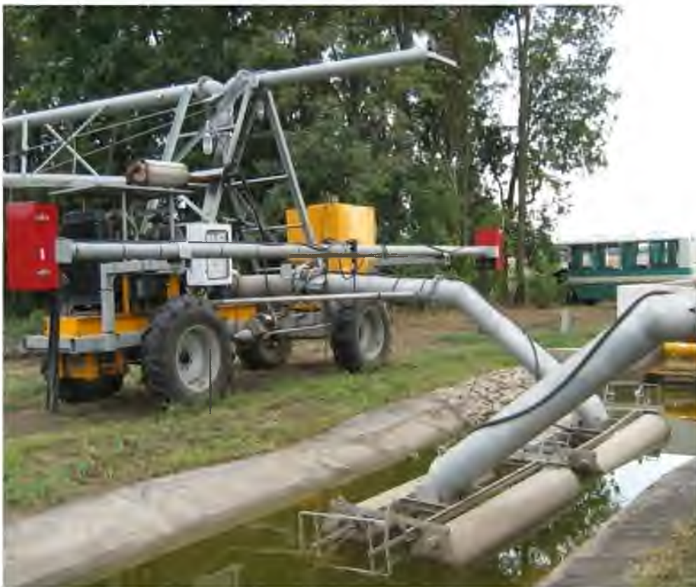
Рисунок 4.22 – Забор воды из канала 12 для полива сельскохозяйственных культур на поле Д (по патенту РФ № 2353088)
