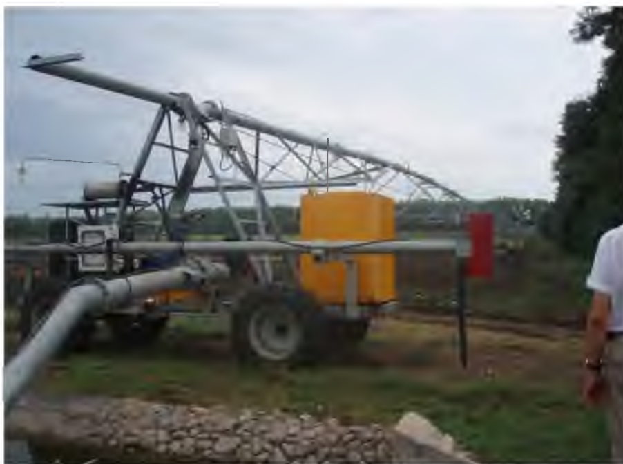
Рисунок 4.21 – Поливная машина Zimatic при поливе посевов кукурузы на зеленый корм по предлагаемому способу
